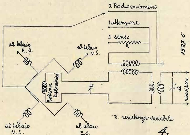
prima lettura, e facendo la media delle due letture. In ogni modo occorre che il telaio sia girevole attorno al proprio asse, e che quindi sia di piccole dimensioni. Di conseguenza bisogna ricorrere a grandi amplificazioni.
