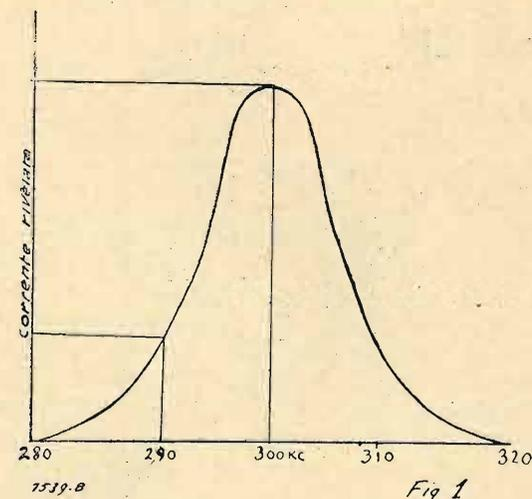
di un rivelatore che sia sensibile alle variazioni della frequenza delle oscillazioni in arrivo, cosicché ad ogni variazione di tale frequenza corrisponda una variazione del valore della corrente rivelata.
