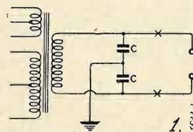
le correnti di A.F. passano apertamente attraverso il circuito. Il fatto è invece da ascrivere al passaggio di correnti di A.F. nel gruppo alimentatore dopo il raddrizzatore o direttamente nel cavo di alimentazione dalla rete d'illuminazione.
