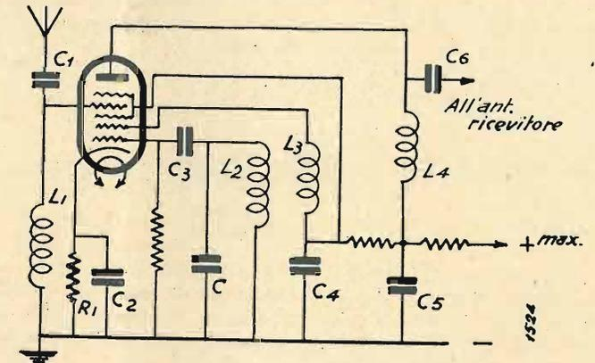
L'antenna è direttamente appoggiata alla griglia della valvola attraverso ad un condensatore C1 del valore di 20 m.m.F. ed aperiodicamente con la bobina L1, per onde corte che deve essere determinata a seconda del campo d'onda che si vuole coprire. Il catodo della valvola è collegato al negativo colla resistenza R1 di 200 Ohm e per mezzo della capacità in parallelo C2 del valore di circa 1 m.F.
