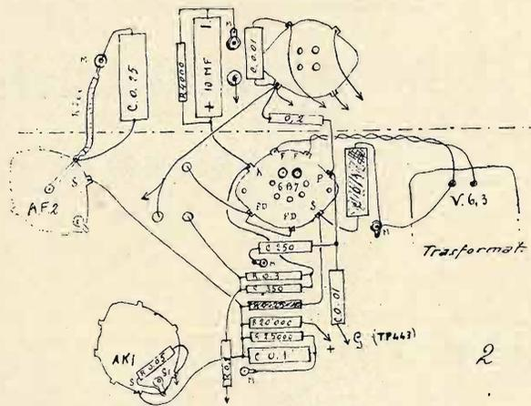
Per l'accensione del filamento si useranno i 6,3 Volta disponibili. Essendo diversa la disposizione dei piedini si è dovuto spostare la posizione dei condensatori e resistenze, inerenti la valvola stessa, come da fig. 2 che modifica parzialmente lo schema costruttivo pubblicato nel n. 5. Tutto il rimanente resta invariato. (Coll'occasione osserviamo che il collegamento alla griglia schermo della AK1 non va a massa ma direttamente alle R 25.000 e 20.000 come da schema elettrico).
