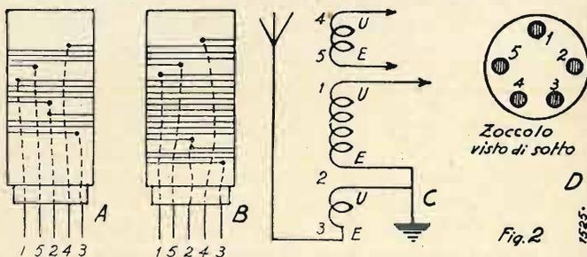
della descrizione, servirà a meglio illustrare la costruzione delle bobine e la disposizione di attacco ai piedini degli zoccoli.
