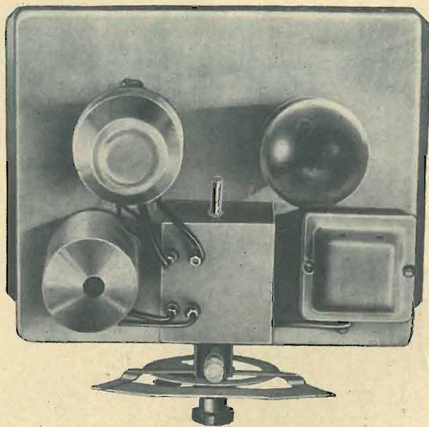
schermo nonchè quelle di accensione. Col nostro metodo, si elimina l'inconveniente di non potere alimentare il filamento dell'ottodo qualora l'apparecchio radio contenesse valvole del tipo americano che si accendono a 2,5 Volta invece che a 4 Volta come richiede l'ottodo.
