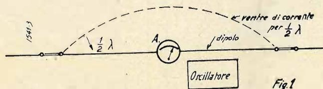
lunghezza d'onda dell'oscillatore è doppia della lunghezza geometrica del dipolo, si ha al centro di esso la massima corrente oscillante, e quindi il microamperometro segnerà un massimo valore di essa.
