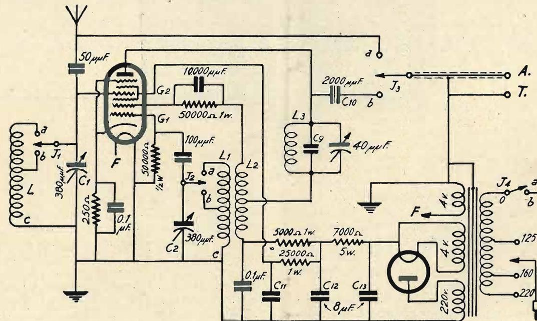
un dato radio segnale, in un'altra frequenza fissa e determinata. Qualsiasi frequenza — si intende compresa nella gamma di accordo prescelta — viene sempre mutata in una seconda frequenza, comunemente chiamata media frequenza.
