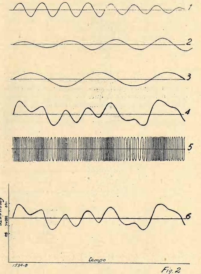
quello ora accennato, ad ogni variazione di frequenza dell'oscillazione emessa corrisponde, nel ricevitore, una variazione della corrente rivelata e che per i tratti rettilinei della curva di fig. 1, l'ampiezza dell'oscillazione agli estremi del rivelatore varia proporzionalmente al variare della frequenza della oscillazione emessa.
